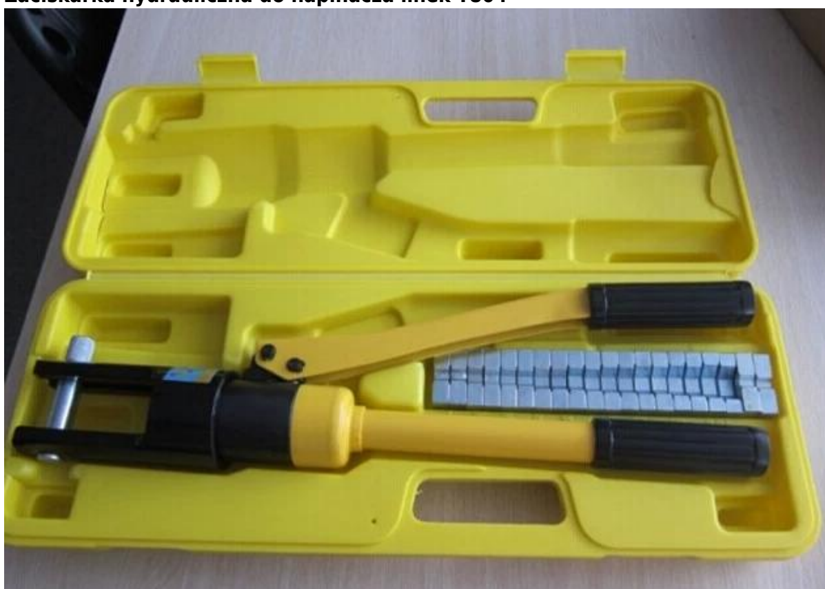
Zaciskarka hydrauliczna do napinacza linek T804 -
