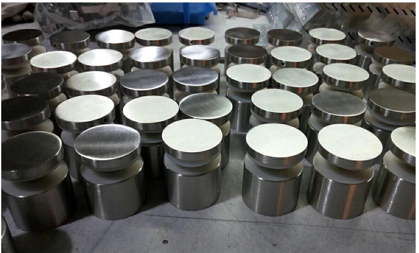
Produkcja i pakowanie zdjęć elementów dystansowych do szkła -
