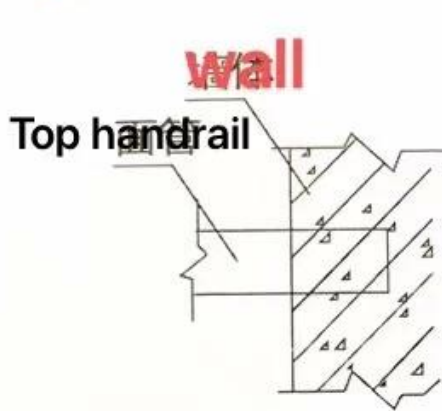
面管入墙固定
