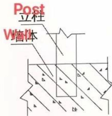
立柱入墙固定
