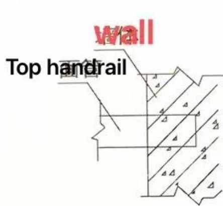
面管入墙固定
