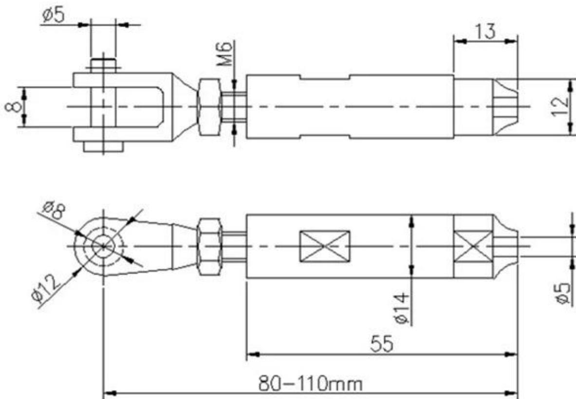
Mais modelos de tensores de cabo disponíveis para diferentes diâmetros de cabo
