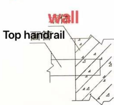
面管入墙固定
