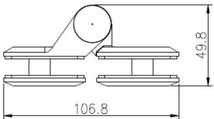
Vidro G-W para coluna quadrada / dobradiça de parede
