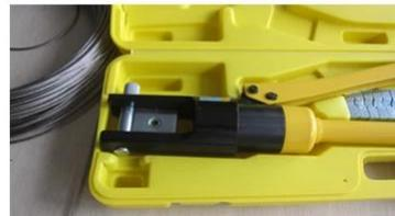
T804, tipo swage, precisa de prensador hidráulico -
