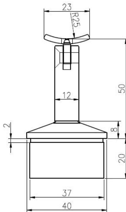
2) Para 50x50mm, tubo de corrimão de espessura de 1.5mm
