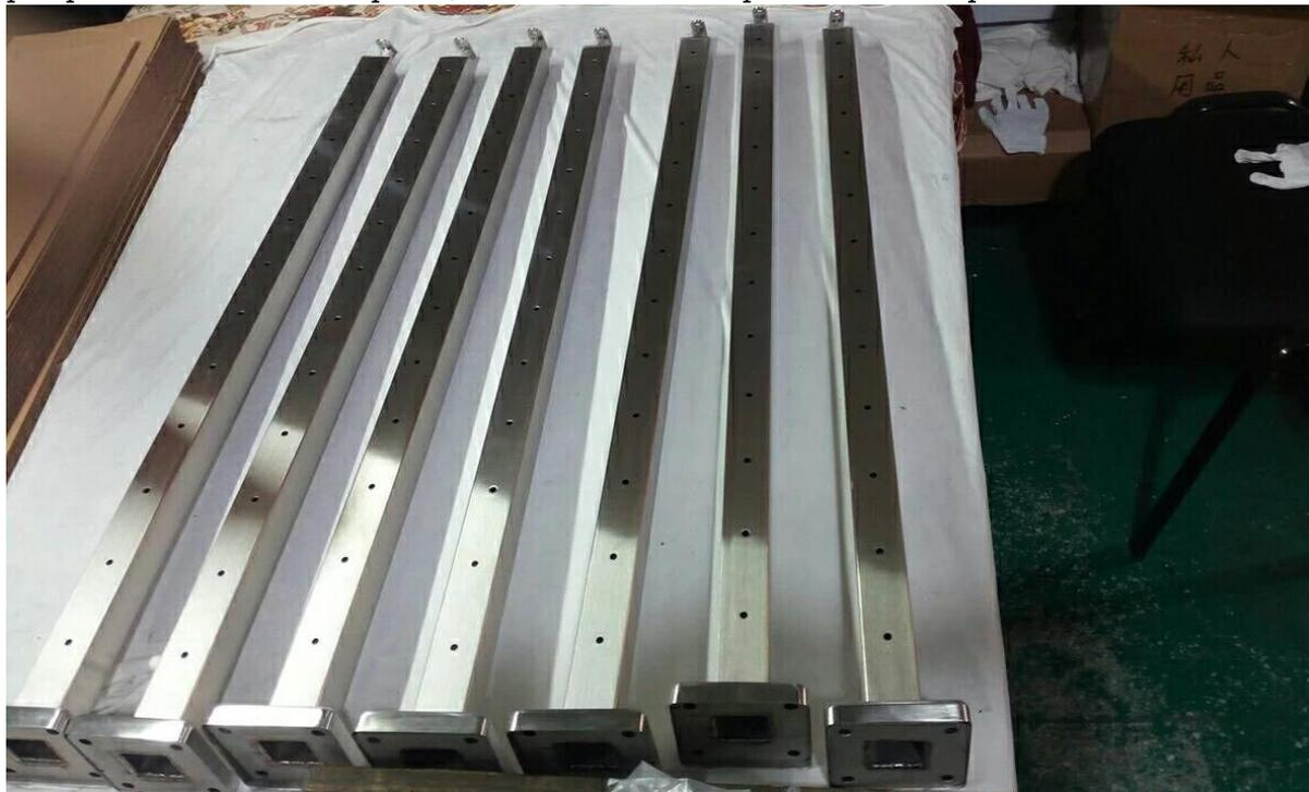
Borne -Round: diâmetro50.8x1.5mm, altura de 1000mm, com suporte do corrimão e tampa da base, pré-perfure furos no poste, tubo de 50,8 mm de diâmetro para o trilho superior
