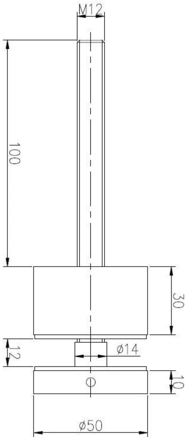
Aplicação: Geralmente um painel de vidro 1.200 milímetros x1000mmx12mm deve ser fixado com 4 pcs impasse
