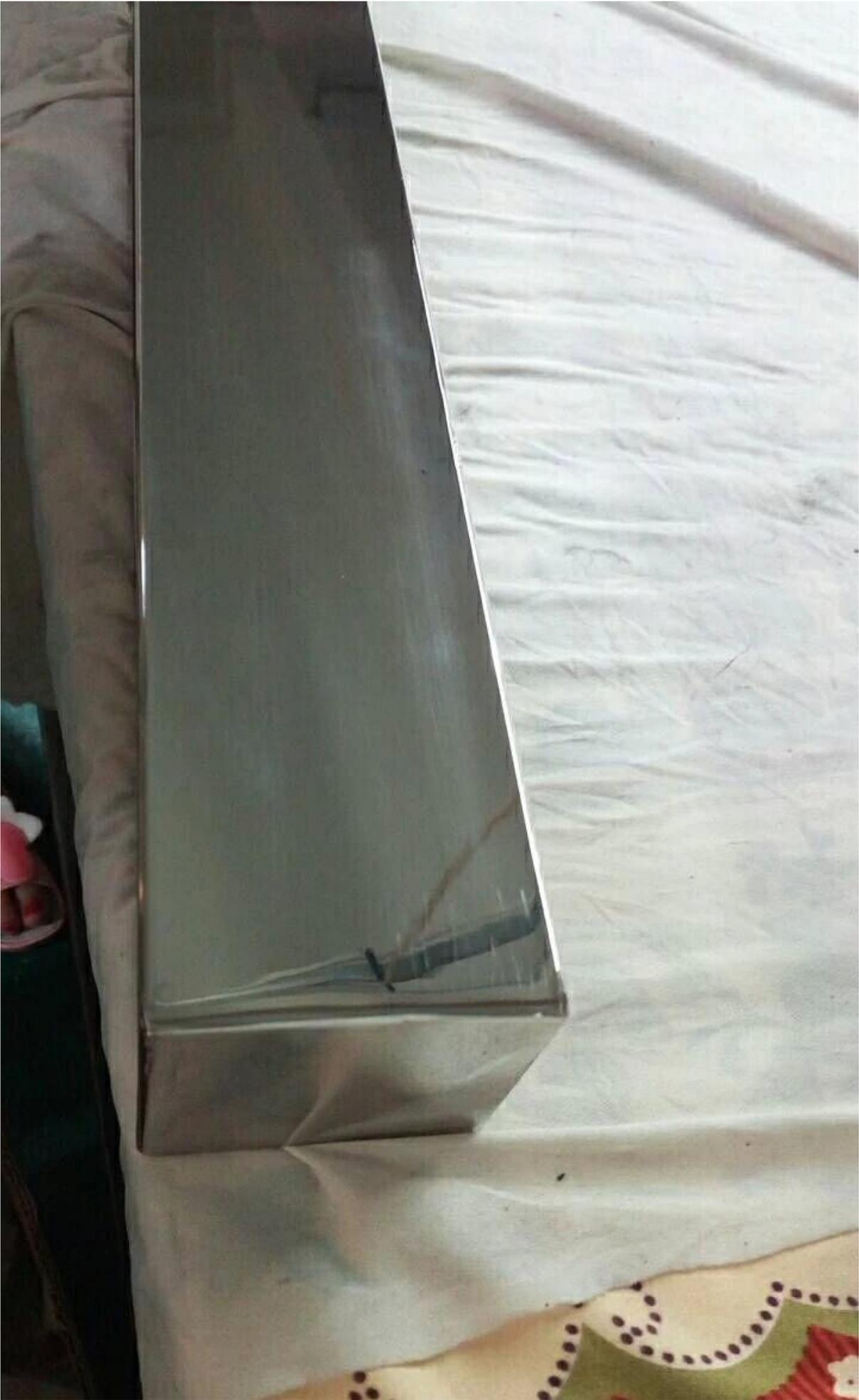
3. post de fotos instalação do quadrado 80x80mm inox com tampa de extremidade selada
