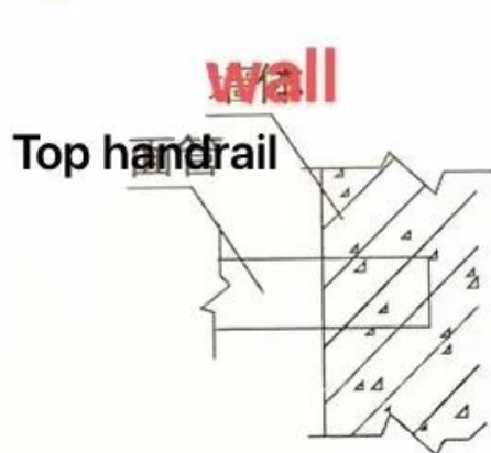
面管入墙固定
