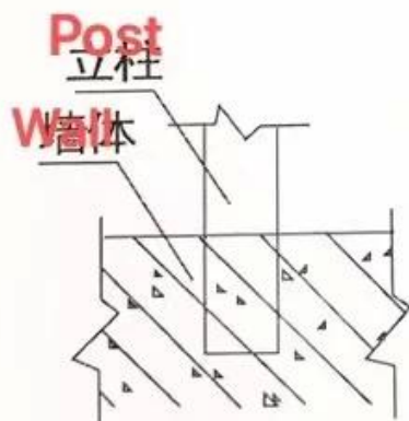
立柱入墙固定
