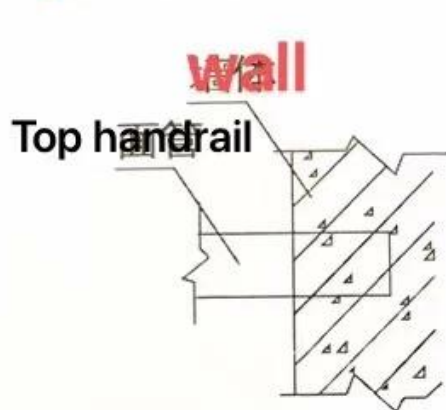
面管入墙固定
