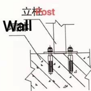
立柱打螺丝固定
