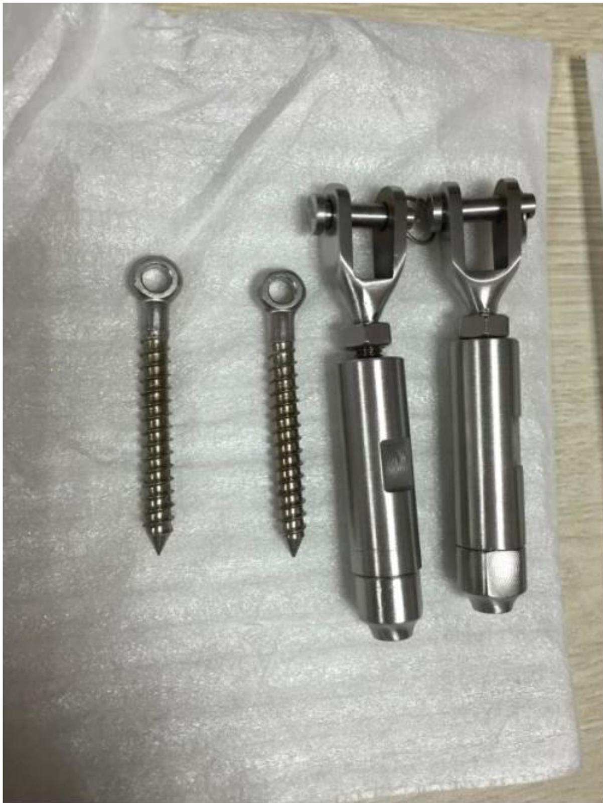
Кабельные рельсовые аппараты Т803 с фиксацией болта в стальной стойке.
