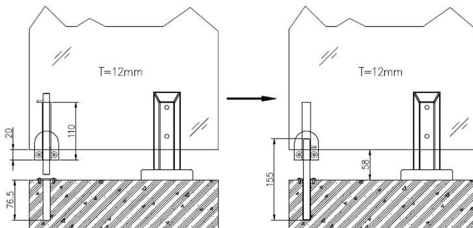
Стеклянная дверь пробка используется в нижней части стеклянной двери, чтобы держать его открытым или закрытым;
