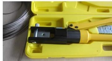
T804, обжимной, нужен гидравлический обжимной пресс -
