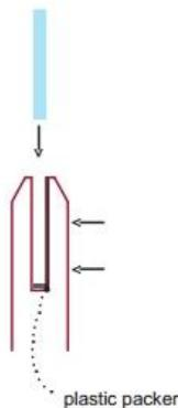
Стеклянный Spigot с регулировкой выравнивания пластины
