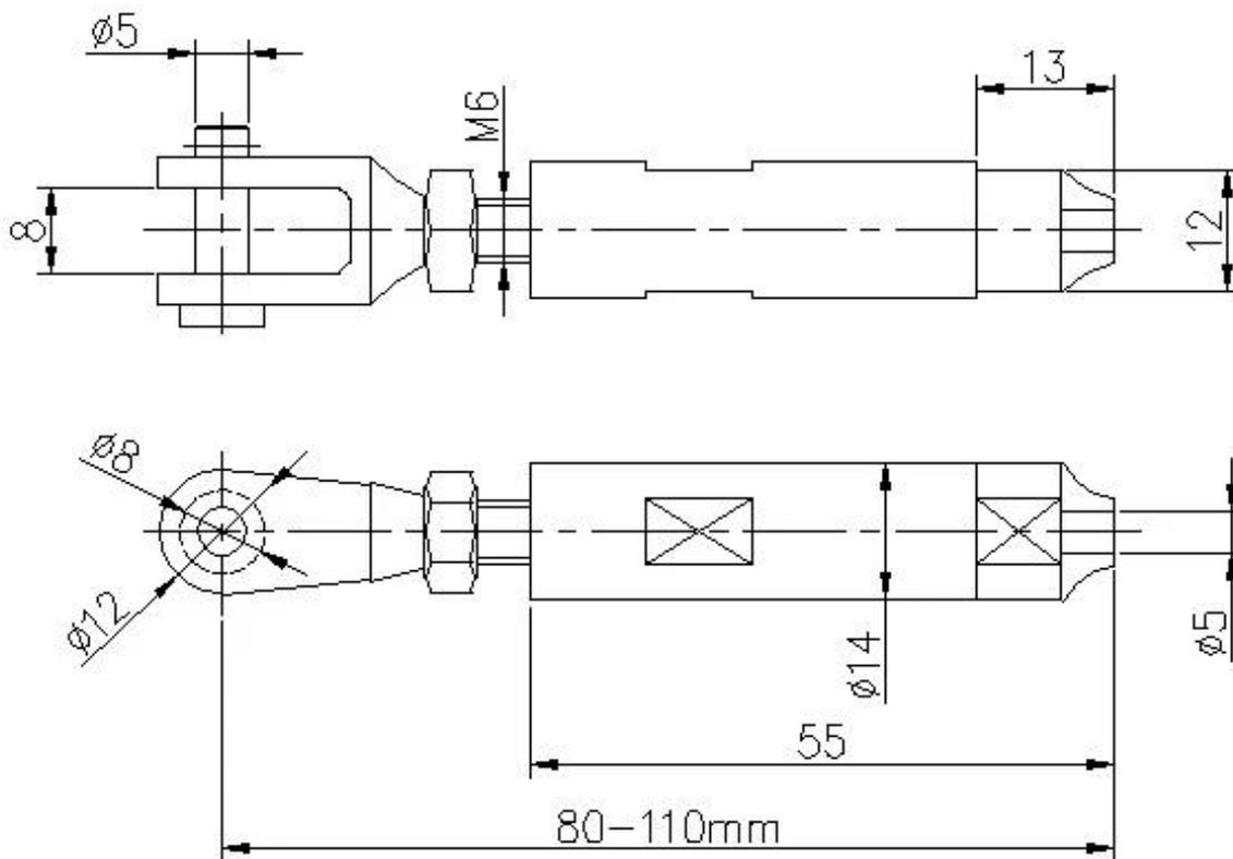
Полный набор из T803. фитинги, незаметного типа; Кабель затягивается путем привинчивания корпуса натяжителя, нет необходимости гидравлического прерывания
