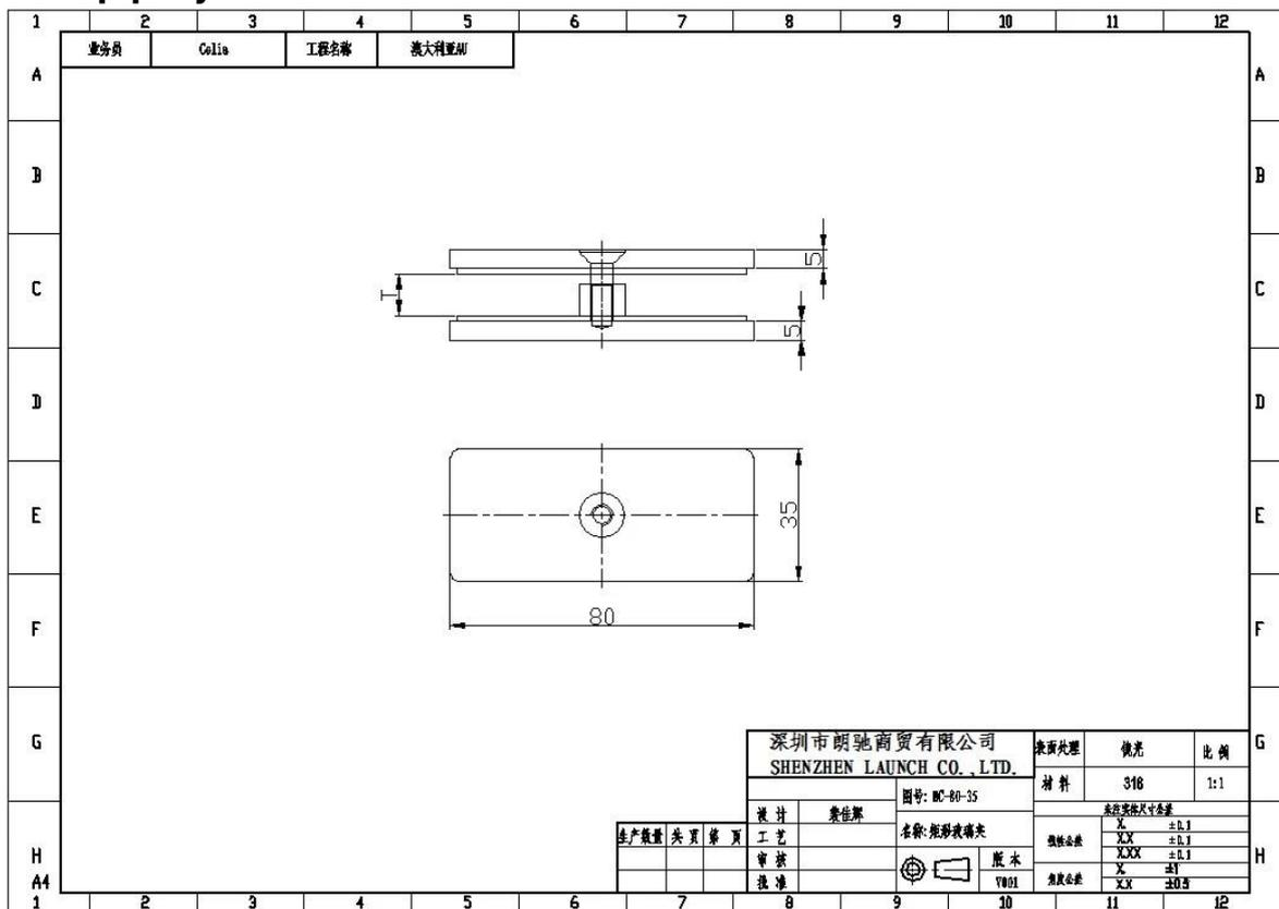
BC-80 \* 35 используется между 2 стеклянной панели, чтобы соединение из них. Более стабильная и безопаснее;
