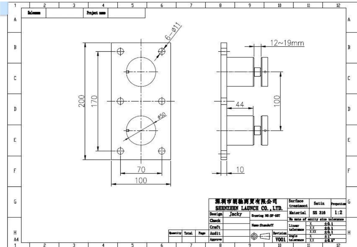
3. из нержавеющей стали 316 морских классов система Противостояние стеклянными перилами проект для вашей справки:
