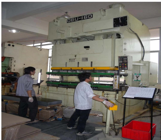
160T 宽台面冲床 模具加工尺寸800*1800mm
