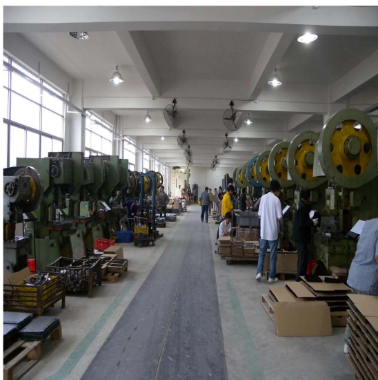
160T 宽台面冲床 模具加工尺寸800*1800mm
