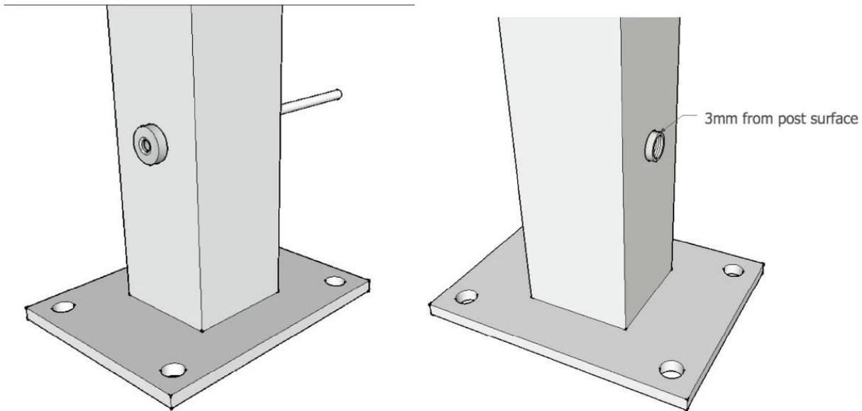
4). **T809** Кабель натяжителя ( Для диаметра 4-6мм кабеля).
